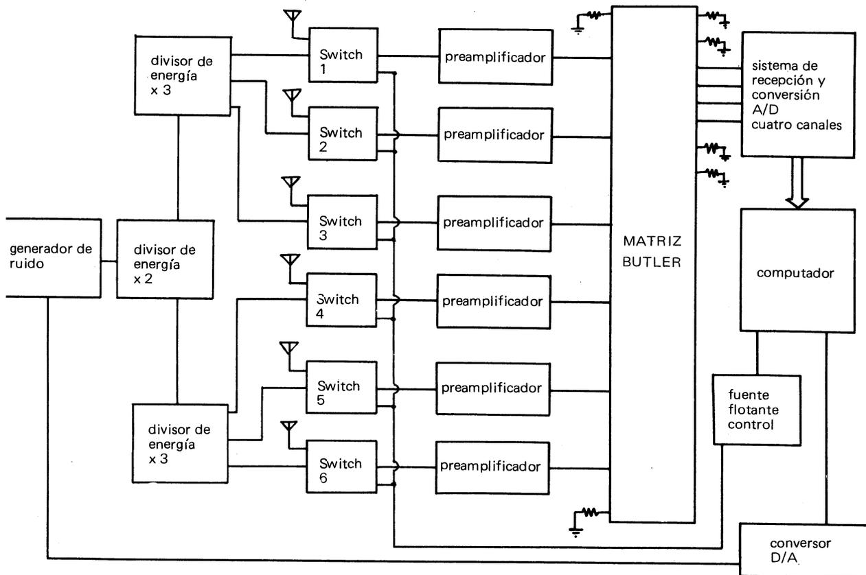
Fig. 4 Diagrama en bloques del sistema de calibración.
