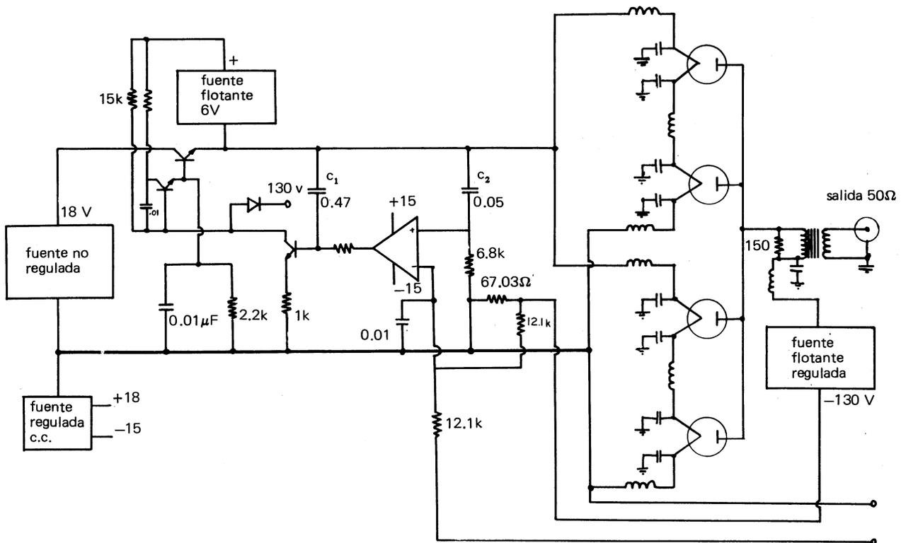
Fig. 3. Diagrama esquemático completo del generador de ruido.
